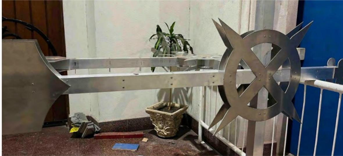
De esta manera, además de la unión química que genera el pegamento epoxi, se estableció una unión mecánica.
