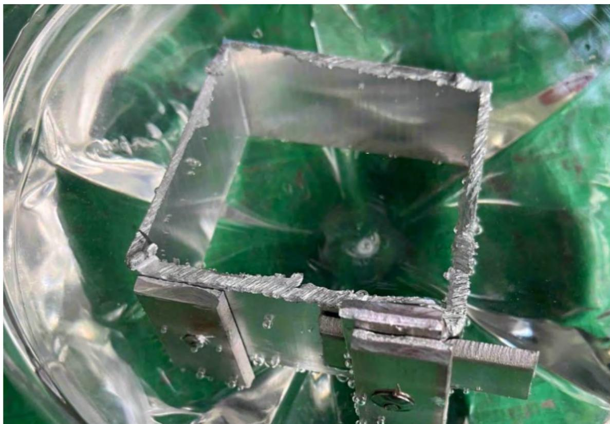
Algo más de 6 meses después, si bien hay descoloración, y signos de “pitting” (corrosión localizada por ataque a la capa superficial del aluminio), no hay ningún signo de corrosión galvánica alrededor del remache. El pitting observado es consecuencia también del agregado de cloro, para simular algunos ácidos que pueden caer junto con la lluvia en ambientes urbanos,
